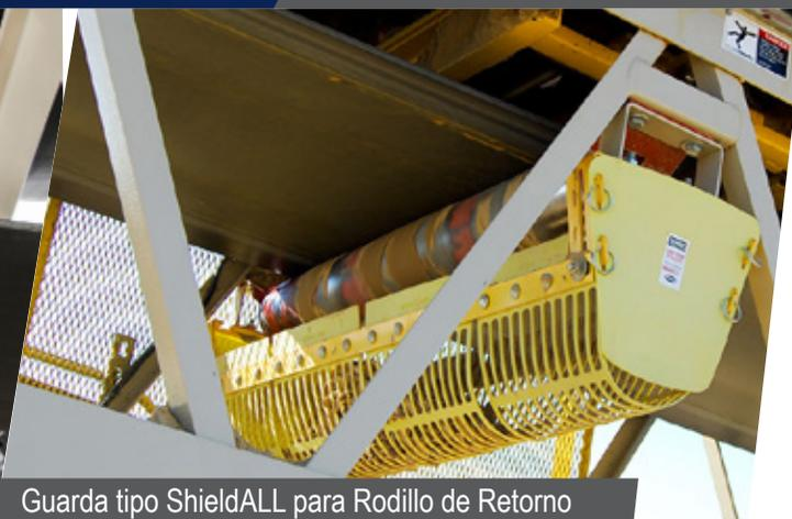
Guarda tipo ShieldALL para Rodillo de Retorno
